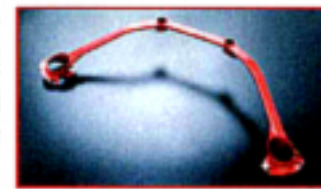
●為適應前置式引擎，AUTOEXE的頭頂Bar已改用U字形設計，以支撐塔頂及擋火牆部份。
