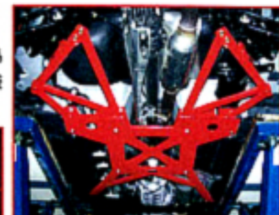
●這件巨大的支撐架安裝於NC型ROADSTER的車底部份，提供可靠的車架剛性強化。
