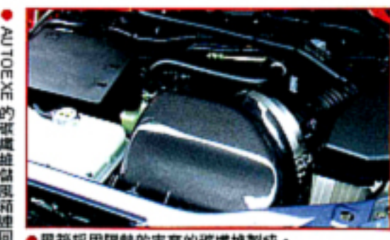
●風箱採用隔熱效率高的碳纖維製成。
