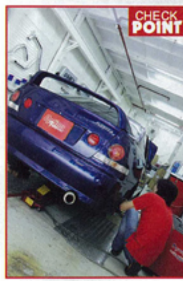
●利用Dynamapack馬力機進行馬力測試，將以尾輪驅動的ALTEZZA尾兩個輪拆裝並分別裝上感應摩打。
