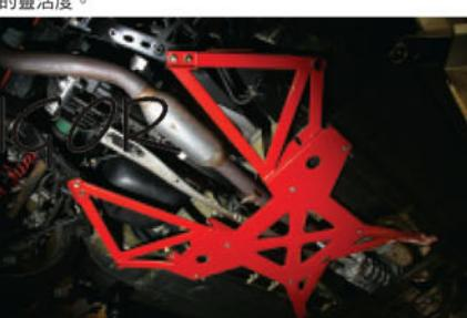
▲ 為了剛性直接得到升級，整個車底裝上超誇張的14點式底架，遍及整個車底，直接令MX-5先天無頂的車架設計及底盤作出最全面的強化。
