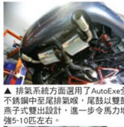
▲ 排氣系統方面選用了AutoExe全不銹鋼中至尾排氣喉，尾鼓以雙鼓燕子式雙出設計，進一步令馬力增強5-10匹左右。
