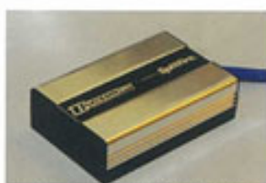
▲ D SPARK MAX主體及線組使用耐熱物料製作，足以抵受引擎的高熱。
